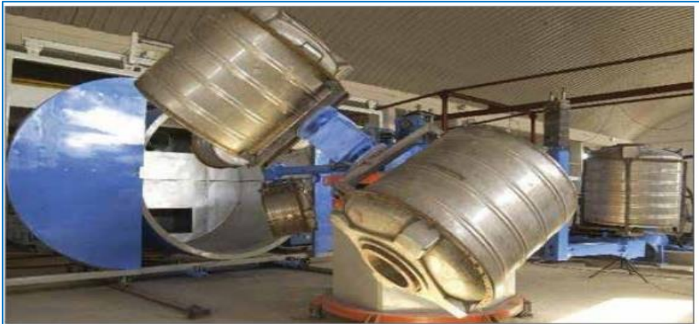
الشكل (13) ماكينة إنتاج البلاستيك بالتشكيل بالدوران
